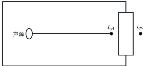
图 4-1 室内声源等效为室外声源图例
